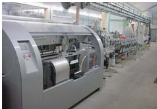
Die neue Linie: Im Vordergrund Schweissmaschine Can Man X8, daran anschliessend Trocknungseinheit Frei ECM zum Aushärten der Pulverbeschichtung, oben Staustrecke.
