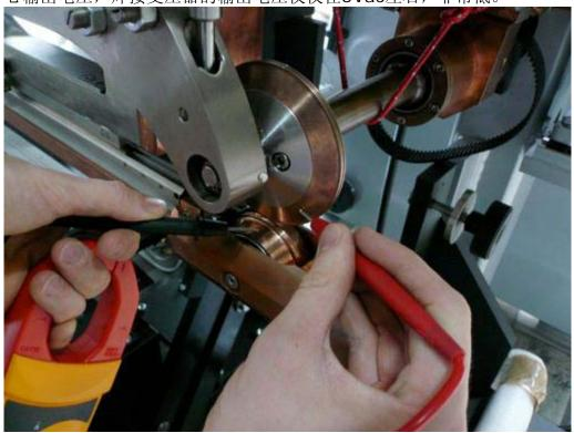
Before you change the transformer step switch off first the external supply!!! 在改变变压器的档位前,关闭外部电源。
